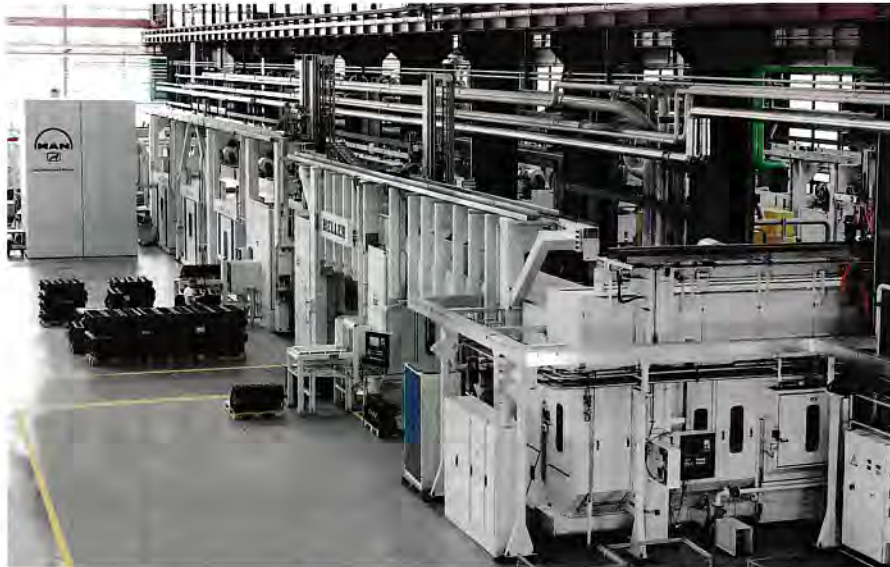
Bild 4: Stark in der Automobilindustrie: komplettes Fertigungssystem von Heller für die Kurbelgehäusefertigung beim Nutzfahrzeughersteller MAN
