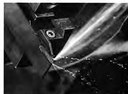
Bild 12: Kühlung direkt in der Schnittzone: die innengekühlte zweischneidige Wendeschneidplatte Typ S224 von Paul Horn
